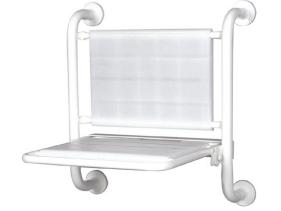
Sedile ribaltabile doccia in acciaio trattato e verniciato con polveri epossidiche. Seduta e schienale in PE-LD antibatterico, facilmente asportabili per le operazioni di pulizia. Carico statico kg. 120 Dimensioni mm. 550x575x475. Colore bianco. Usare viti e tasselli adeguati alle caratteristiche della parete sulla quale verrà installato il prodotto.
