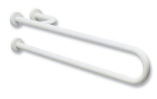
Barra di sostegno con fissaggio a muro realizzato in acetalico (materiale plastico ad altissima resistenza) studiato in collaborazione con il Politecnico di Milano per rispondere alle seguenti esigenze: 1) resistenza a carichi sul maniglione di almeno 150 kg, 2) perfetto isolamento elettrico per evitare la trasmissione di correnti vaganti. Vite di fissaggio in acciaio inox.
